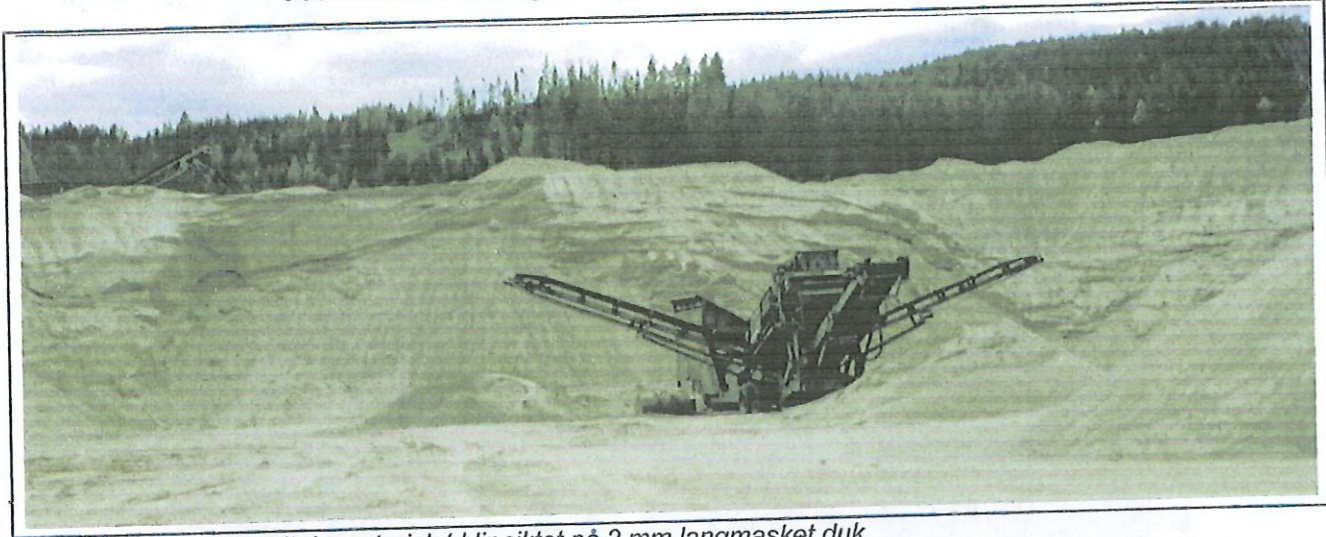
Sandtaks materialet blir siktet på 2 mm langmasket duk.
